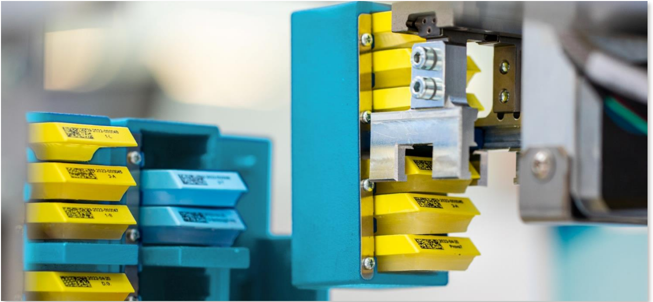
Détail de la famille de pincettes électriques LEHZ de SMC utilisées pour la manipulation de blocs dans la machine FlexPath™ Blox d'Inpeco.
