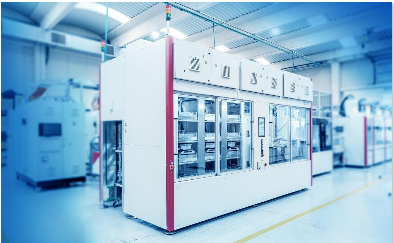
*Machine de test de déverminage OBC par IPTE*
