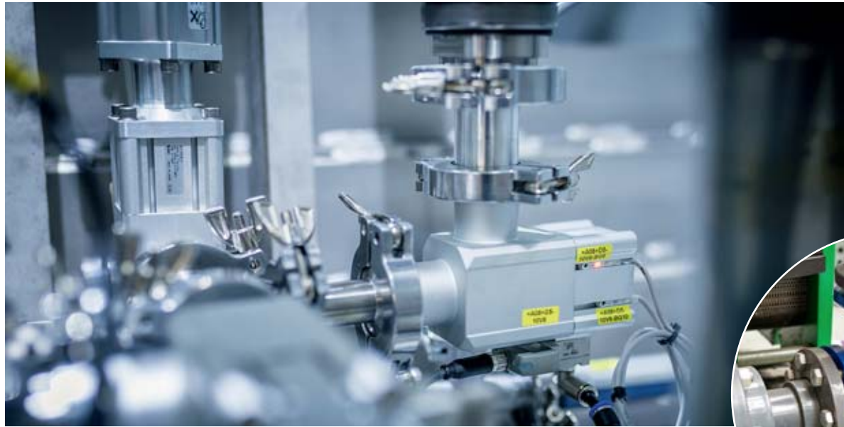
Um die Ecke denken: Die Eckventile haben austauschbare Faltenbalg-Dichtungen und pneumatische Antriebe – das spart Zeit und Geld bei der Wartung, weil nicht das ganze Ventil getauscht werden muss.
