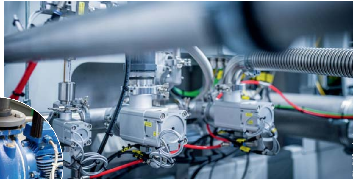
Erkennen, wenn es leckt: Eine Dichtheitsprüfanlage identifiziert mit Hilfe von Hochvakuum-Eckventilen schnell und sicher Leckagen.
