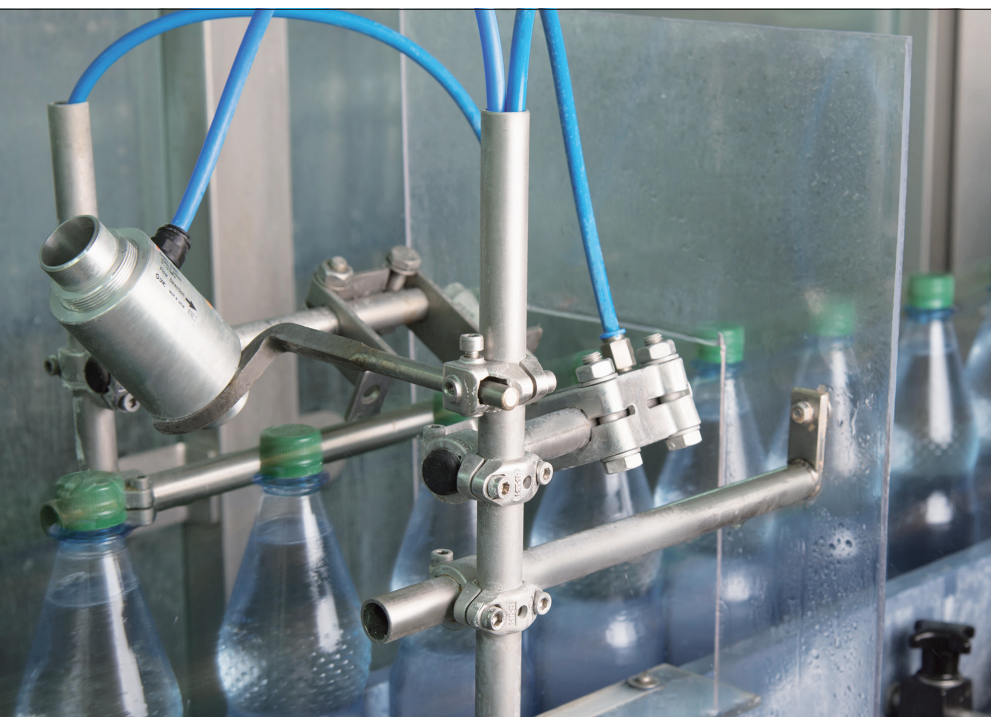
Die Volumenstromverstärker von SMC bringen mithilfe des Venturi-Prinzips Luftströme kostengünstig auf Höchstgeschwindigkeit. (Foto: SMC)
