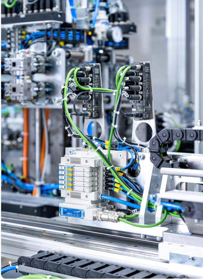
Voll vernetzt: Die SY-Ventilinseln sind mit verschiedenen Busprotokollen kompatibel. Einzelne Ventilfunktionen können zudem geändert und beispielsweise IO-Link- oder OPC-UA-Schnittstellen ergänzt werden. (Bild: SMC)
