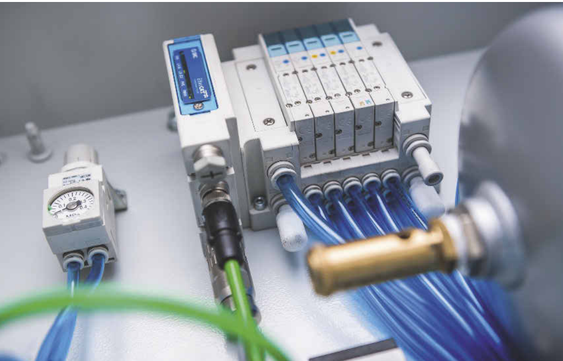
Ventile der Serie New SY von SMC lassen sich einfach auf einer Ventilinsel kombinieren, auch in verschiedenen Baugrößen. Bilder: SMC Deutschland
