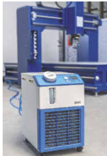
Das Temperiergerät HRS012 von SMC hält die Temperatur des Fräskopfes mit einer Genauigkeit von \pm 0,1 °C konstant.
