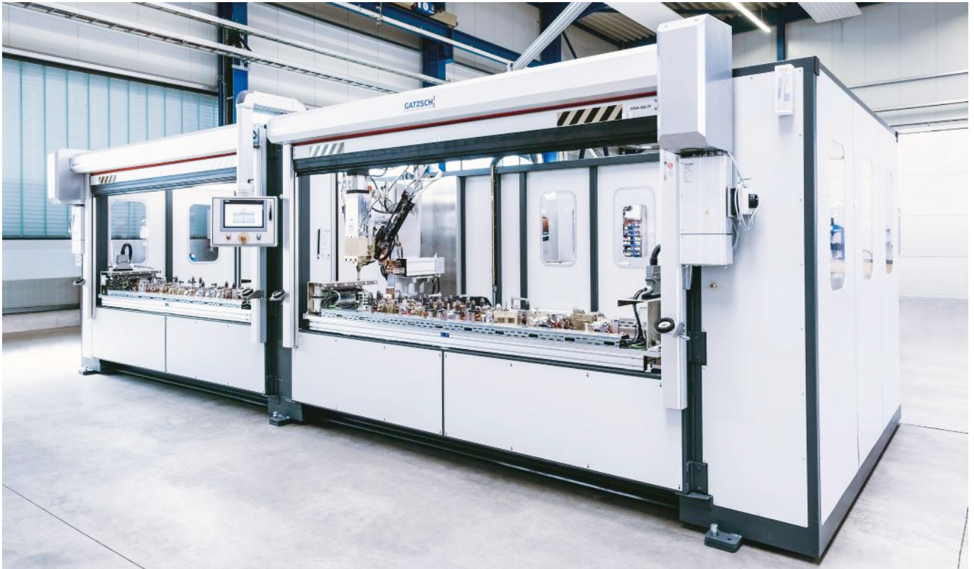
Die Widerstands-Buckelschweißanlage von Gatzsch verarbeitet beispielsweise Lkw-Komponenten sicher und präzise mit SMC-Lösungen.
