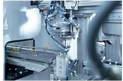
**Bild 4** An der Wendestation bekommt die mechatronische Baugruppe ihren Deckel – Zylinder der Serie MGPM von SMC sorgen beim Herausnehmen, Drehen und Platzieren für hohe Stabilität. (Bild: SMC Deutschland)
