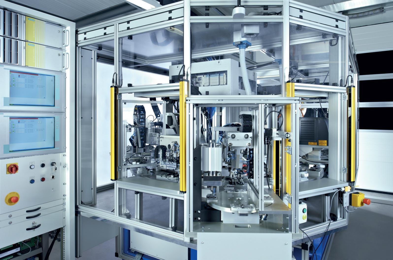
**Bild 1** Eine große Bandbreite an pneumatischen Technologien von SMC treibt die zwölf Stationen des Rundschalttellers von Gaedigk an: vom Greifer der Serie MHZ2 bis zur modularen SY-Ventiliinsel (Bild: SMC Deutschland)
