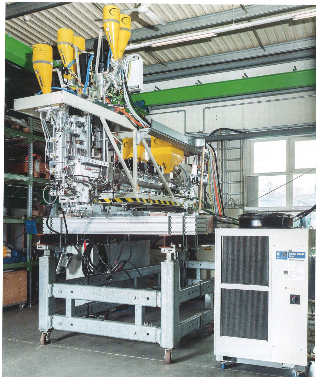
Strom, Gewicht und Größe sparen: Dank einer frequenzgesteuerten Regelung von Motor, Gebläse und Pumpe ist das Temperiergerät kompakt und mobil (© SMC)
