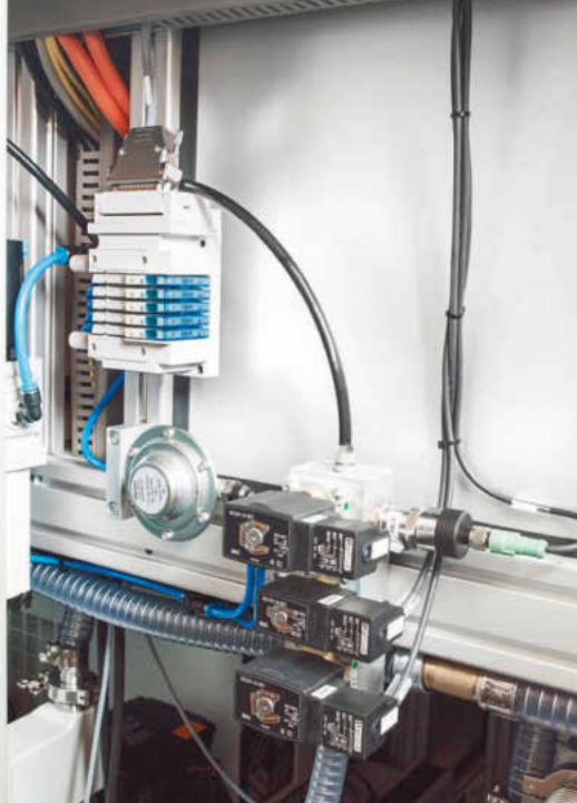
Ventilinsel für die pneumatischen Spannbewegungen und der Ventilblock für das Prüfgashandling.
