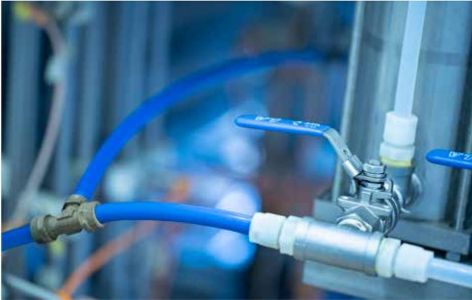
Die neuen Schläuche der Serie PD01 aus PVDF (Polyvinylidenfluorid) sind mit den mit Öl betriebenen Niederhydraulik-Zylindern der Casomatic verschlaucht.
