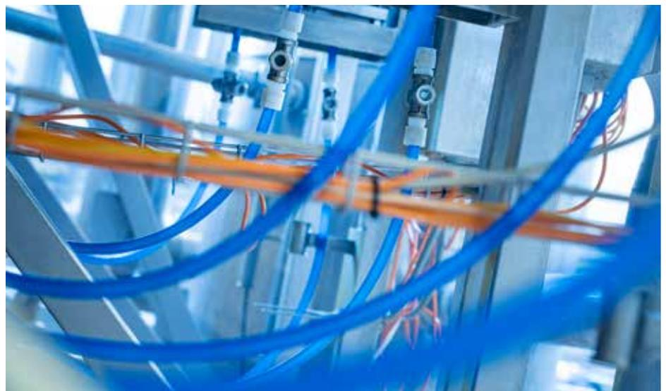
Resistent gegenüber Säuren, Laugen und Ölen besitzt der Schlauch der Serie PD01 auch bei Temperaturen von bis zu 120 °C einen extrem hohen Berstkurven-Verlauf und lässt sich zusätzlich flexibler verlegen.
