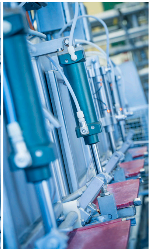
Die Aluminium-Zylinder der Serie C96HYB helfen, die Molke abzapfen und sorgen dank keimunterdrückender Antihafbeschichtung für optimale Hygiene
