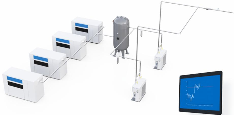
Die letzte Phase besteht darin, den Auslegungsdruck zur Versorgung des Betriebs **zu senken**, um den **Kompressorbedarf zu reduzieren**.
