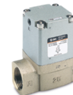
Pneumatisch betätigtes 2/2-Wege-Ventil mit externer Vorsteuerung Serie VNB
