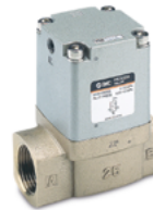
Pneumatisch betätigtes 2/2-Wege-Ventil mit externer Vorsteuerung Serie VNB
