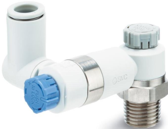
**Abbildung:** Die dank Steckverbindung einfach und schnell montierbaren Drosselrückschlagventile der Serie ASD-A von SMC bieten zwei Geschwindigkeitsregler zur parallelen Zuluft- und Abluftsteuerung und wiegen mit 21 g ganze 28 % weniger als bestehende Modelle. Foto: SMC Deutschland GmbH
