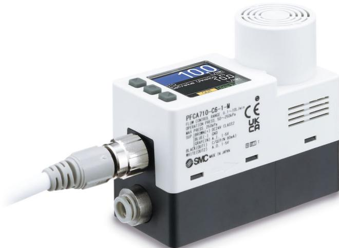
**Abbildung:** Durch die Integration von Durchflusssensor, Regelventil und Steuerung in einer Einheit profitieren Anwender beim Durchflussregler der Serie PFC710 von weniger Verschlauchung sowie Verkabelung und erhalten dank IO-Link- und analoger Kommunikationsoption mehr Flexibilität.
