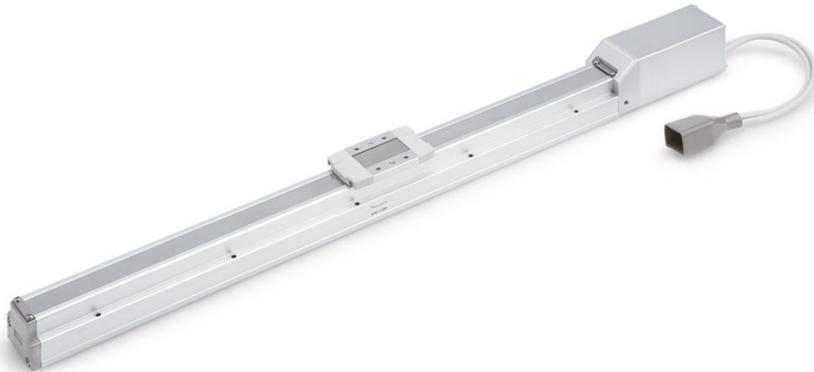
**Abbildung:** Der neue elektrische Antrieb der Serie LEFS#G realisiert u.a. dank batterielosem Absolut-Encoder, einer Beschleunigung von bis zu 10000 mm/s<sup>2</sup>, einer Geschwindigkeit von bis zu 1500 mm/s und kurzen Zykluszeiten High-Performance-Anwendungen in verschiedenen Branchen.
