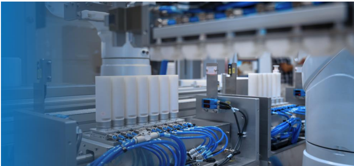
Die Teile werden mit den kleinsten auf dem Markt erhältlichen pneumatischen Drehantrieben von SMC um 15 Grad gedreht.
