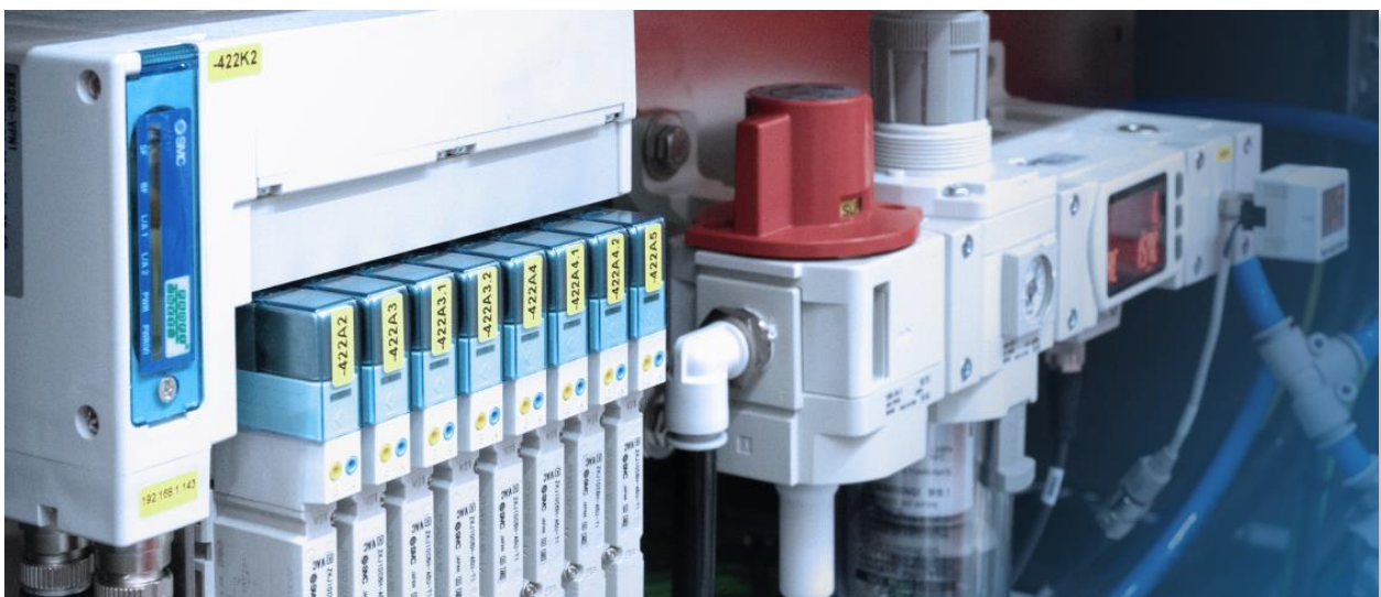
Die Vakuumerzeugung (links) erfolgt über eine modulare Insel, in die Ejektoren, Busknoten und ein Überwachungssystem integriert sind
