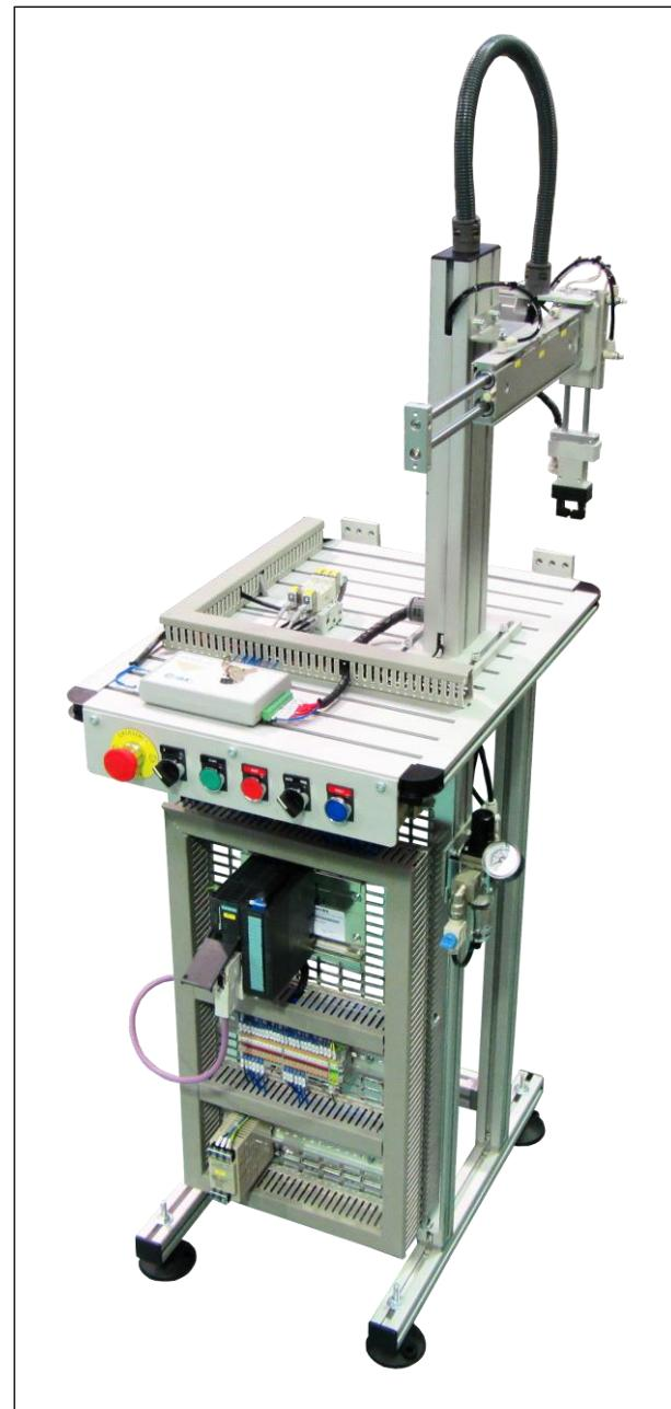
Stanica je izvedena iz aluminijске konstrukcije dimenzija 450x600x900mm na koju su postavljene komponente koje se koriste za izvođenje postupka, kao što su ventilski blok za upravljanje pneumatskim aktuatorima. Stanica dolazi sa samostojećim postoljem podesivim po visini.
