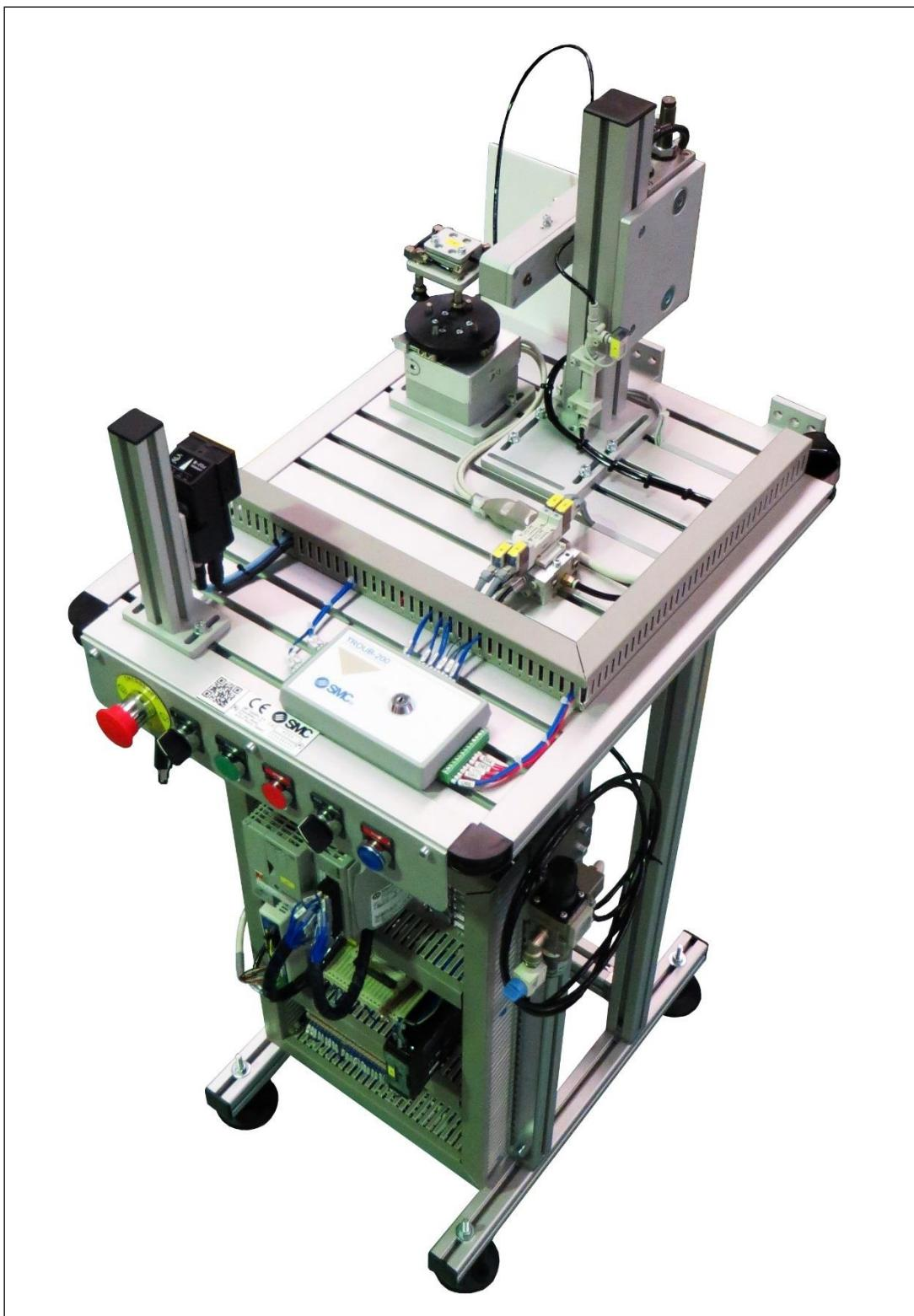
Sustav provjerava visinu ležaja, materijal osovine, visinu i materijal poklopca te zatezni moment 4 vijka u sklopu.
