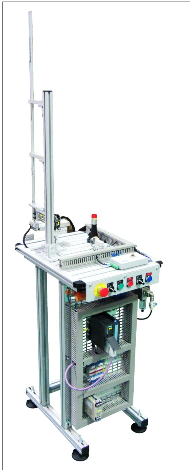
Stanica je izvedena iz aluminijске konstrukcije dimenzija 450x600x900mm na koju su postavljene komponente koje se koriste za izvođenje postupka, kao što
