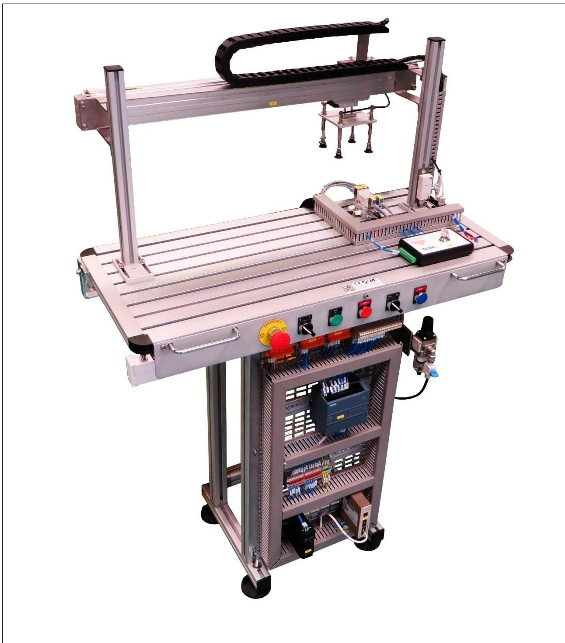
Dio za premještanje je paleta od crnog najlona koja nosi rotacijski mehanizam. Stanica je izvedena iz aluminijске konstrukcije dimenzija 900x410x900mm na koju su postavljene komponente koje se koriste za izvođenje postupka, kao što su ventilski blok za upravljanje pneumatskim komponentama. Stanica dolazi sa samostojećim postoljem podesivim po visini.
