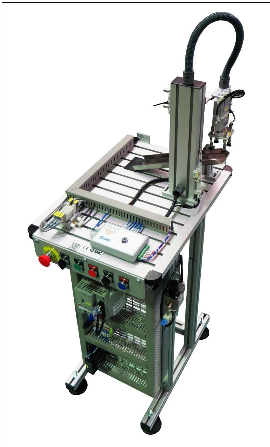
Stanica je izvedena iz aluminijске konstrukcije dimenzija 450x600x900mm na koju su postavljene komponente koje se koriste za izvođenje postupka, kao što su ventilski blok za upravljanje pneumatskim aktuatorima. Stanica dolazi sa samostojećim postoljem podesivim po visini.
