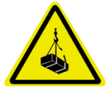
Risiko - angehobene Last
