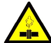
Risiko - unter Druck stehende Leitungen
